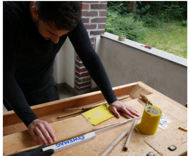
Der Bambus muss zunächst auf die gleiche Länge geschnitten werden und anschließend die Enden glatt gefeilt werden, sodass sich die Insekten nicht an scharfen Kanten verletzen können.
